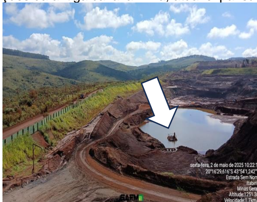
Figura 6-34: Fundo da cava do dique com a água pluvial sendo retida para aspersão interna.
