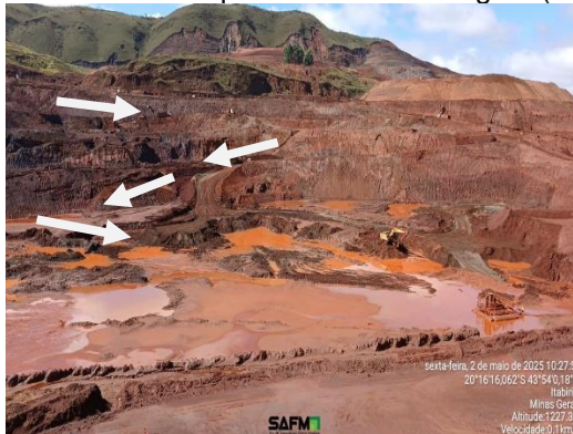
Figura 6-28: Fundo da Cava do Dique que recebe a contribuição das barragens Central e Aredes.
