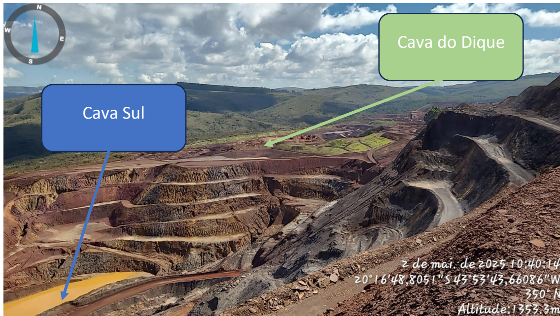
Figura 6-23: Duas cavas para as quais as águas pluviais são direcionadas na mina.
